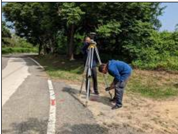
衛星定位、精準可靠-運用 E-GNSS 辦理圖根補建，加速複丈處理。
